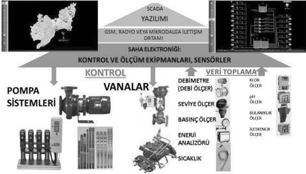
Şekil 1: İçme Suyu SCADA'sı
